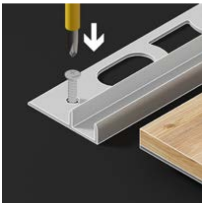
fixar a base em alumínio ao suporte com parafusos ou cola
