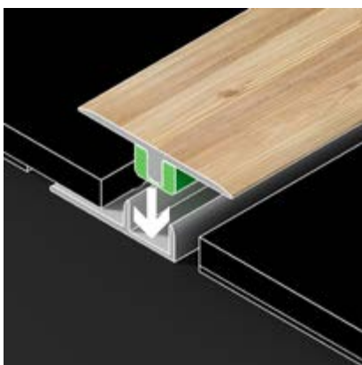
encaixar o perfil de topo na base
